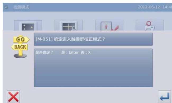
需要进行 5 点的校正，最好采用触摸笔一类工具点击画面中的十字光标，校正结束后会显示提示信息显示本次操作是否成功。
