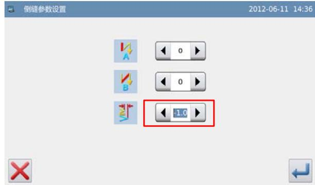
两点缩缝宽度调整在倒缝时可以让最初的落针点到下一落针点的宽度变窄（设定值为 0 时不修正）。
